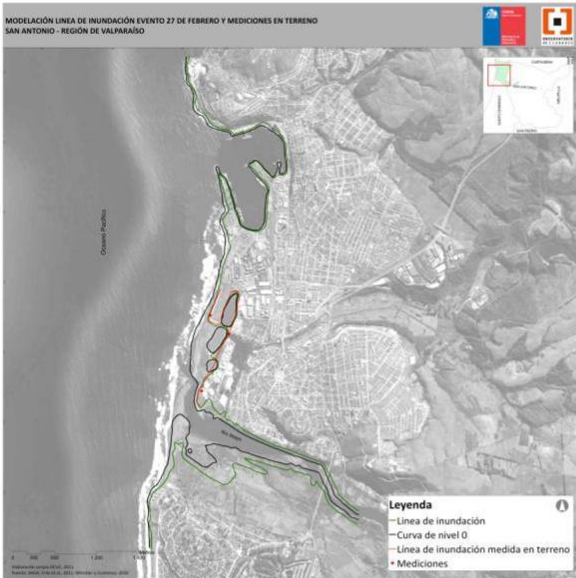
Figura 11: Línea de inundación estimada tsunami 27 Febrero 2010 y puntos tomados en terreno. Fuente: Elaboración propia con datos de Fritz et al. (2011) y Winckler y Contreras (2010).
